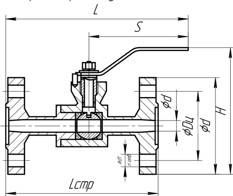
Трёхсоставная конструкция корпуса
